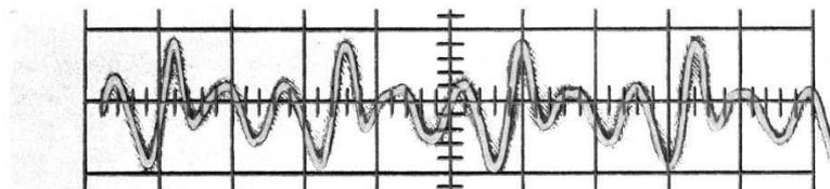
*Schwingungskurve (Oszillogramm) eines Trompetentons*
