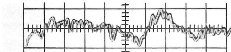
*Die unregelmäßige Schwingungskurve eines Trommelschlags*
