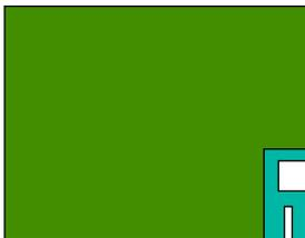
1. Ein mit einer elektrisch aktiven Schicht überzogene Platte wird mit Photolack bedeckt.
