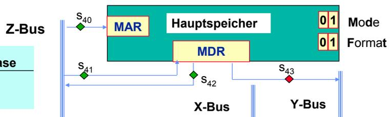
Der Arbeitsmodus des Hauptspeichers wird in den Mode Schaltern eingestellt:
