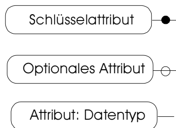
Abb. 2.6: Attribut Konstrukte des ER-Modells
